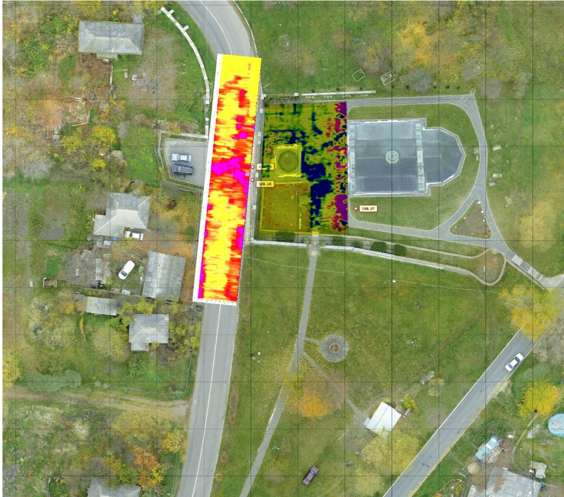
Рисунок 11 – Просторова ситуація навколо Іллінської церкви на глибині 5,5 м за георадарними даними
